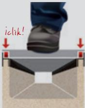
CIERRE RÁPIDO DE SEGURIDAD SIN TORNILLOS. 8 fijaciones por metro lineal
